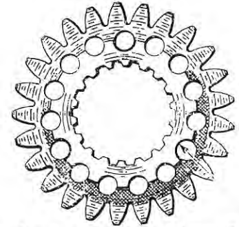
Abb. 3 - Betätigung f. 2. Gang (2. Montage)
