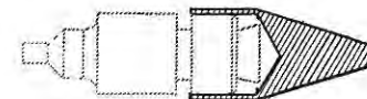
Abb. 4 - Konus für die Dichtungen am Kolben des Druckreglers, erhältl. unter der Nr. 2226-T
