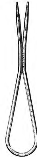
Abb. 3 - Vorrichtung zum Ein- und Ausbau der Stützfedern für die Bremsbacken. Erhältl. unter Nr. 3556-T
